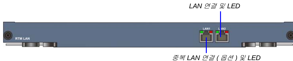
그림 1-4 RMX 2000 RTM LAN 뒷면 패널 레이아웃
